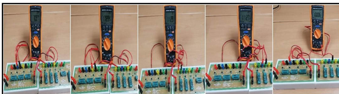
Rajah 16. Pengujian nilai voltan litar gabungan siri-selari
