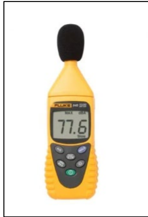
Rajah 3: Pencerapan data lapangan menggunakan Sound Level Meter
